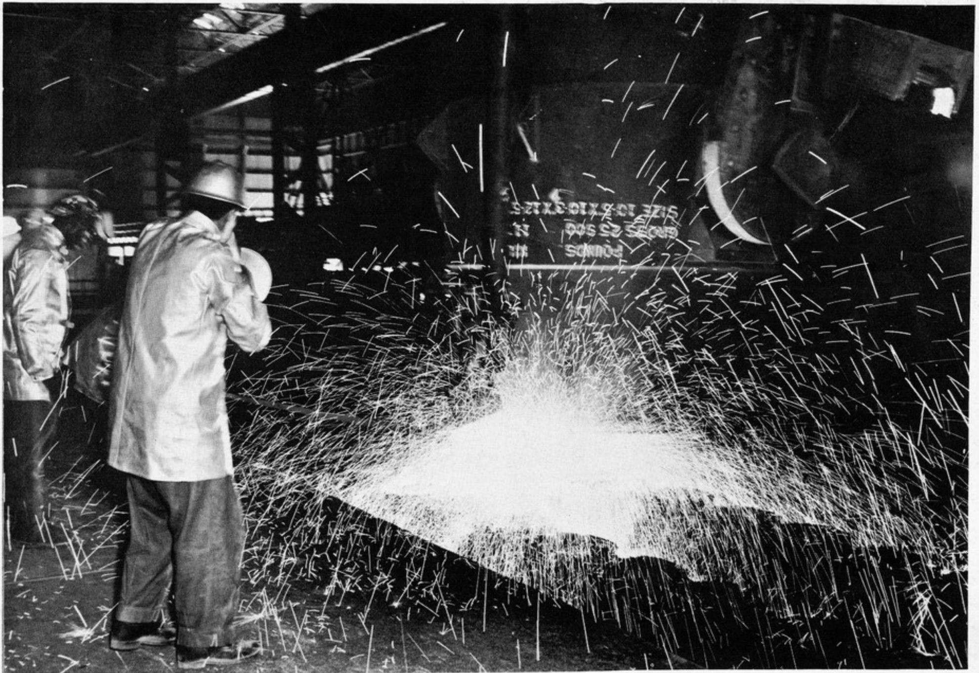
Estos técnicos observan el proceso y la grúa hace descender el cubilote sobre las dos hileras de moldes a los que va llenando lentamente. A la derecha, el campo de chatarra de la planta y la grúa que mediante un electroimán levanta con facilidad pesadas cargas de acero.
